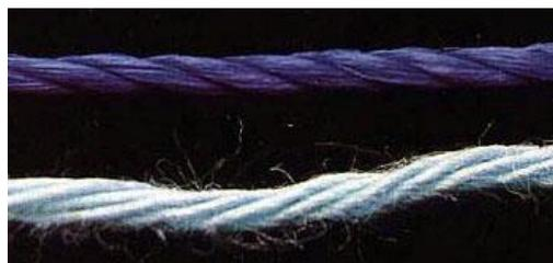
Рисунок 1 – Фотография деформирования синтетической нитки до и после воздействия пружины шпульного колпачка
